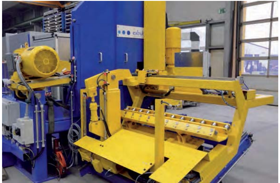
Säge zum Trennen von warmen und kalten Stangen (Endmontage) Saw for cutting hot and cold logs (final assembly)
