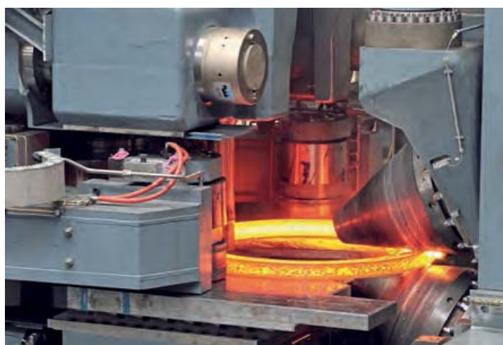
Die maximale Axial- und Radialkraft beträgt jeweils 6.300 kN
