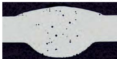
Abb. 4: 100% Argon, 500 ppm Feuchte
