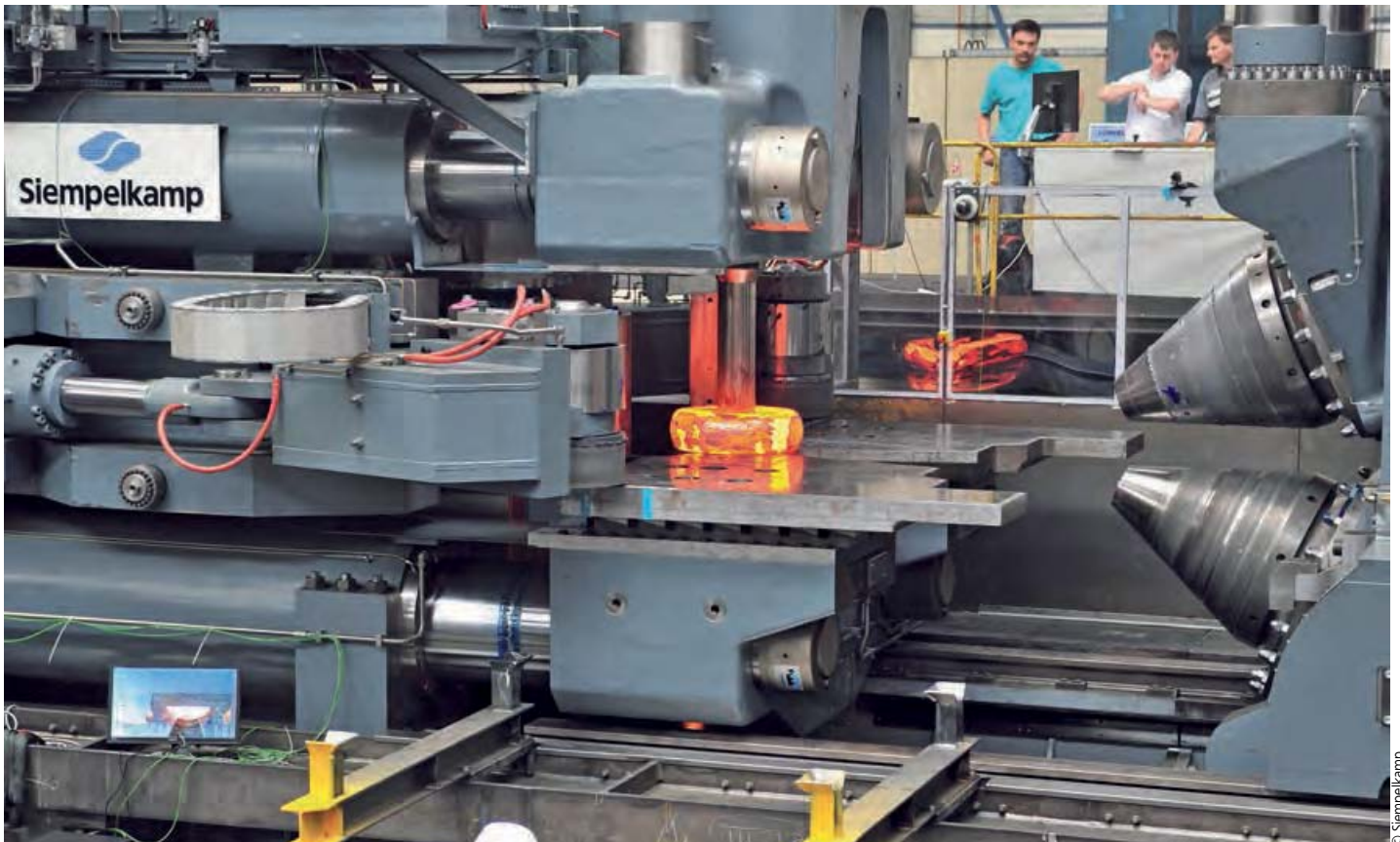
Die Ringe entstehen aus Rohlingen, die von einer weiteren Siempelkamp-Pressen hergestellt werden The rings are made of billets manufactured on another Siempelkamp press
