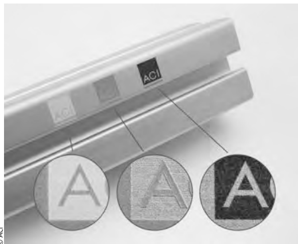
Laserbeschriftungsarten auf Aluminium im Vergleich (v.l.n.r.): Weißbeschriftung mit YAG Laser, Gravurbeschriftung mit Faserlaser, Schwarzbeschriftung mit neu entwickeltem ACI Laser
