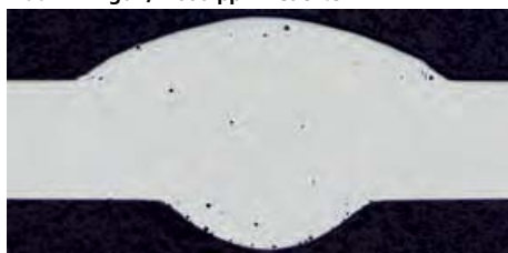
Abb. 3: 100% Argon, 300 ppm Feuchte
